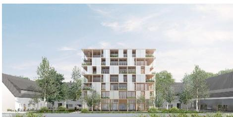
TubeCube ist ein freistehender, vielleicht etwas zu mittig im Hof sitzender Solitär. Der edel wirkende Neubau steht im Kontrast zur Ruppigkeit des Bestands. Der Entwurf ist holzbaugerecht geplant mit einer im Grundriss symmetrischen Konstruktion mit Betonkern, einer vertikalen Lastabtragung aus Brettsper Holz wänden und -stützen und einer lebendigen Fassadengliederung mit verschiebbaren Sonnenschutzelementen.
