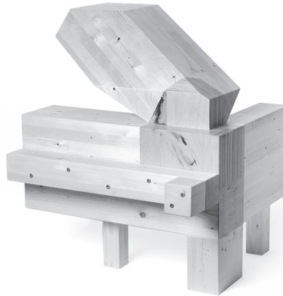
Nachbau eines Eckknotens im Tragwerk der Max Felchlin AG im Maßstab 1:2
