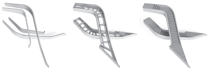
Die Treppe in Stavanger ist als torsionssteifer Trogquerschnitt konstruiert. Für die seitlichen Wangen und die Querträger wurden Brettschichtholz-Träger verwendet, für die Stufen Buchenurnierschichtholz.
